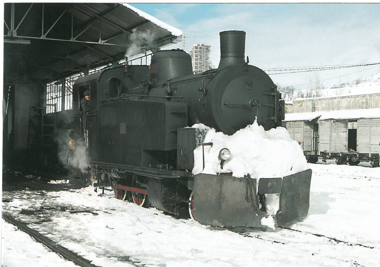
Foto 11.5: le sempre più frequenti ed abbondanti nevicate nel sud della Penisola, costringono le varie amministrazioni ferroviarie ad utilizzare ogni tipo di mezzo in caso di necessità. È il caso di questa anziana 401 a vapore (CEMSA 1931) delle ex Ferrovie Calabro-Lucane, a scartamento ridotto, utilizzata nella notte del 30 gennaio 1976 per sgomberare i binari dalla neve nella zona intorno a Potenza e ripresa nel locale deposito.
